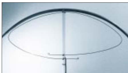
Bild 2: Die Koppelschleife ist oberhalb des Polyamidstabes befestigt
